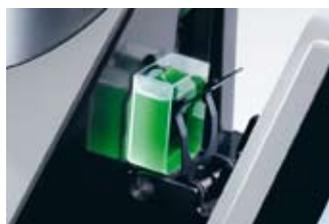
Измерение жидкостей методом пропускания
