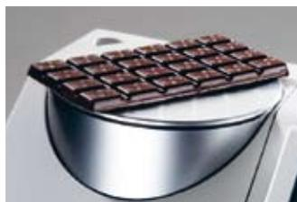
Измерение твёрдых образцов методом отражения
