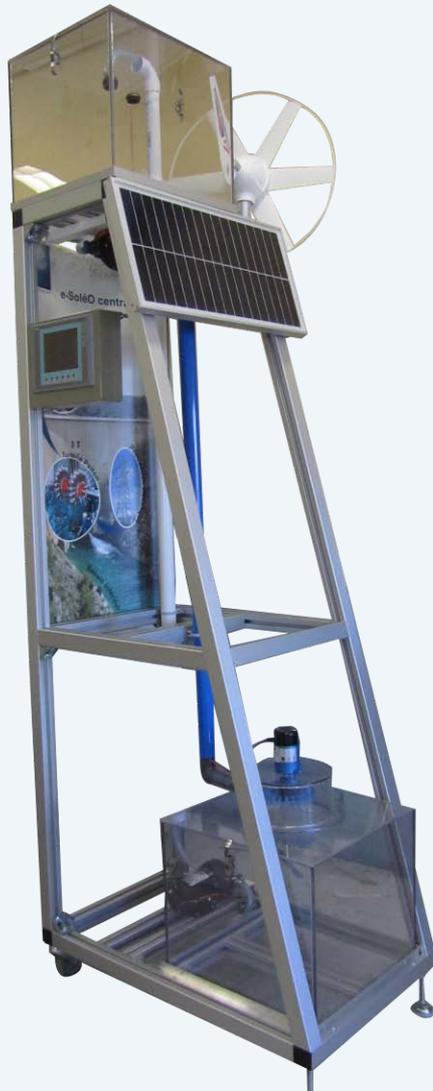
**Стенд e-SoléO представляет собой прототип гидроаккумулирующей электростанции. Он также демонстрирует получение электроэнергии за счёт ветряной и солнечной энергии:**
