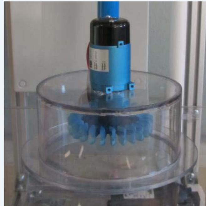
Турбина Pelton и генератор
